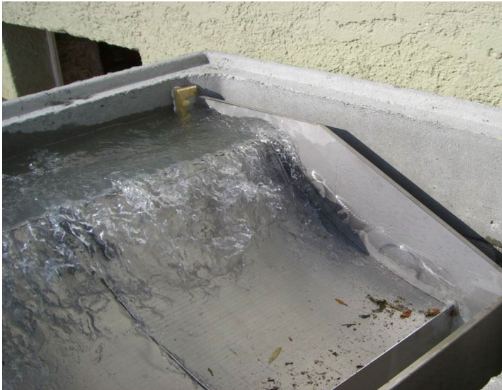
Bogensiebfilter: Spaltweite: 0,3mm
